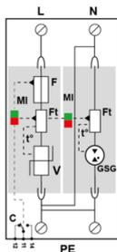
V: высокоэнергетический варистор Ft: тепловой предохранитель F: защита от перегрузки по току (предохранитель) t: Система термического отключения C: Контакт дистанционного сигнала MI: индикатор отключения
